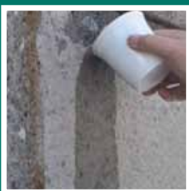
Podłoże bardzo chłonne – szybkie wchłanianie wody
