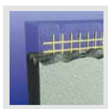
Beton stanowi pasywną warstwą ochronną wokół zbrojenia (pH około 12,5–13,2). Istotna jest jej grubość i ciągłość
