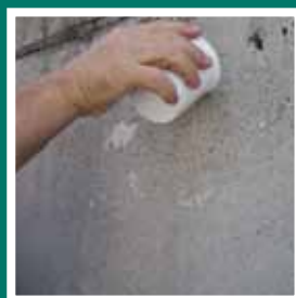
Podłoże niechłonne – sphywanie wody z powierzchni
